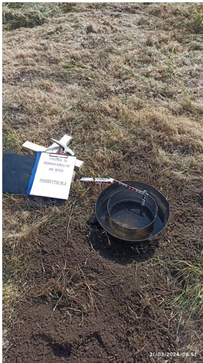
Foto 2. Prova di infiltrazione effettuata sul fondo di uno scavo, poco al di sotto della copertura pedologica.
