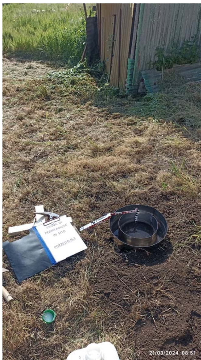
Foto 1. Prova di infiltrazione effettuata sulla copertura pedologica (suolo)
