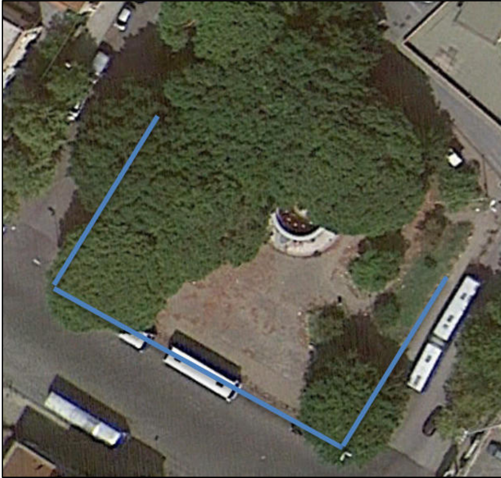
La linea blu indica il posizionamento degli elettrodi sul terreno
